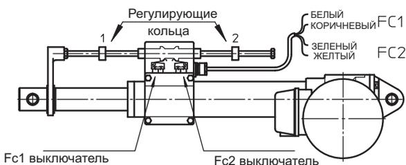
Два электрических ограничителя, установленных внутри герметичной пластиковой коробки, активируются с помощью двух регулируемых колец через воротник вала. **Стандартные ограничители подключаются как NC, длина кабеля 1,5м; провода 4 x 0,75мм**. По запросу они могут подключаться как NO или CS (по наличию конфигураций, пожалуйста, свяжитесь с Отделом Технической Поддержки).
